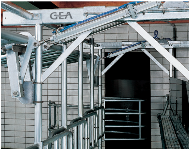
Cylindres pneumatiques gérant la barrière frontale
